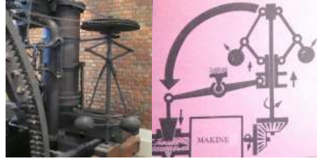
Şekil 3. Mekanik yolla yapılan geri besleme (Guvernör) ile sistemin denge durumunun otomatik olarak kontrol edilmesi.
